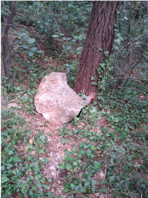
Zone 31.6 : Bloc éboulé récemment : La plaie sur le tronc du pin est encore fraîche.
